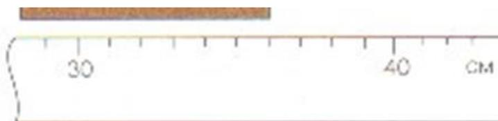
Определим цену деления линейки, показанной на рисунке. Для определения цены деления линейки выберем два соседних числа на шкале, например, 30 см и 40 см. Из большего числа вычтем меньшее число и разделим полученную разность на количество делений – 10. Цена деления линейки – 1 см.
